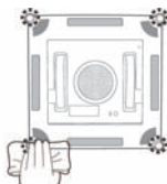
Limpier los sensores de borde
