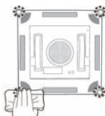
Nettoyer le capteurs de bord
